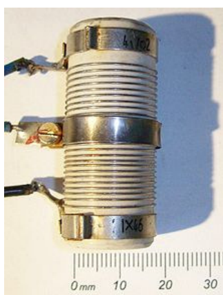
Рис. 3.5. Конструкция проволочного резистора
